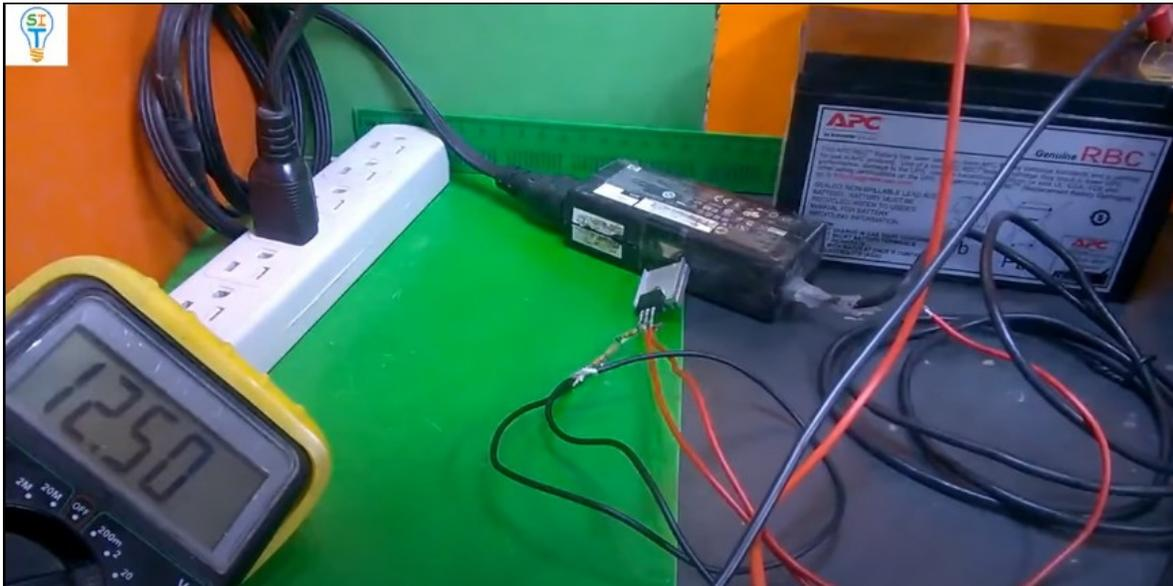
Pero de todas maneras se va a conectar, para prensarlo pueden usar un caimán, positivo con positivo en la batería y negativo con negativo.
