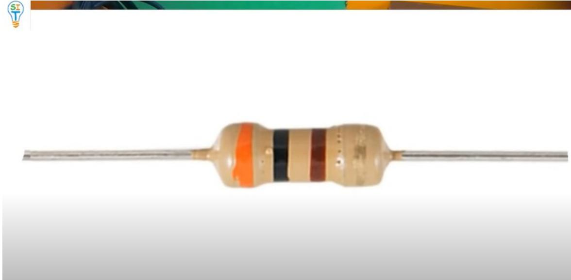
Dos resistencias, una de 1 kilo y otra de 2 kilos, para ponerlas en serie y lograr un valor de 3 kilos que es el que va a servir.
