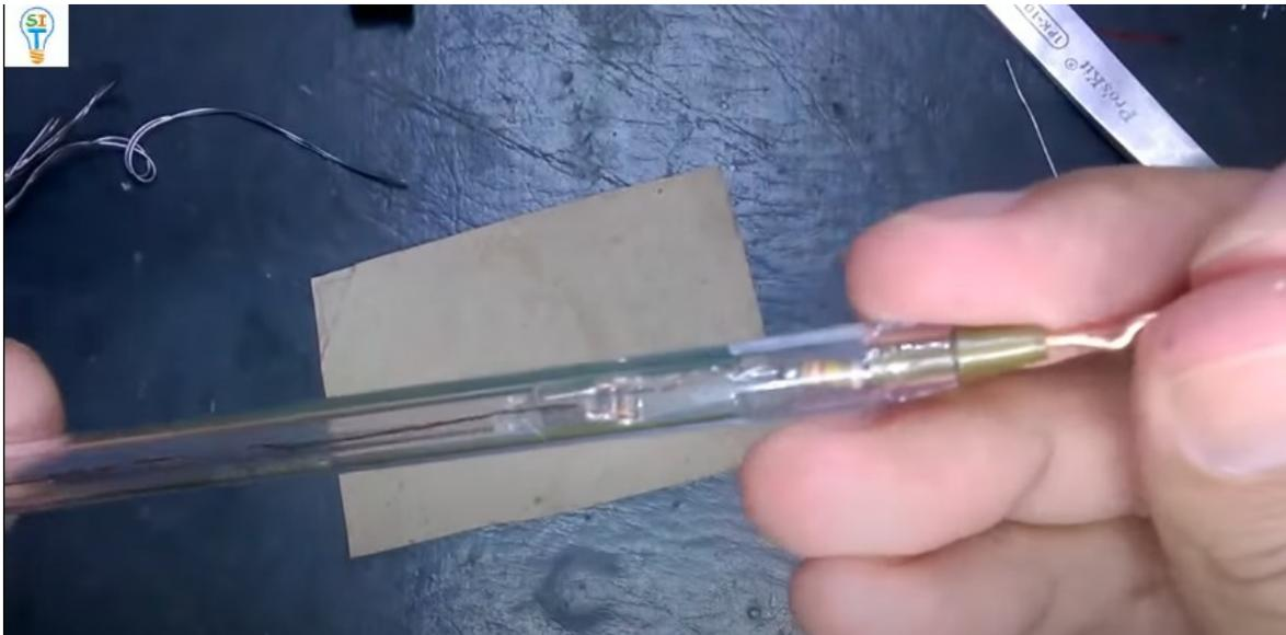
Con el cutter raspar todo el alambre de 0.3mm
