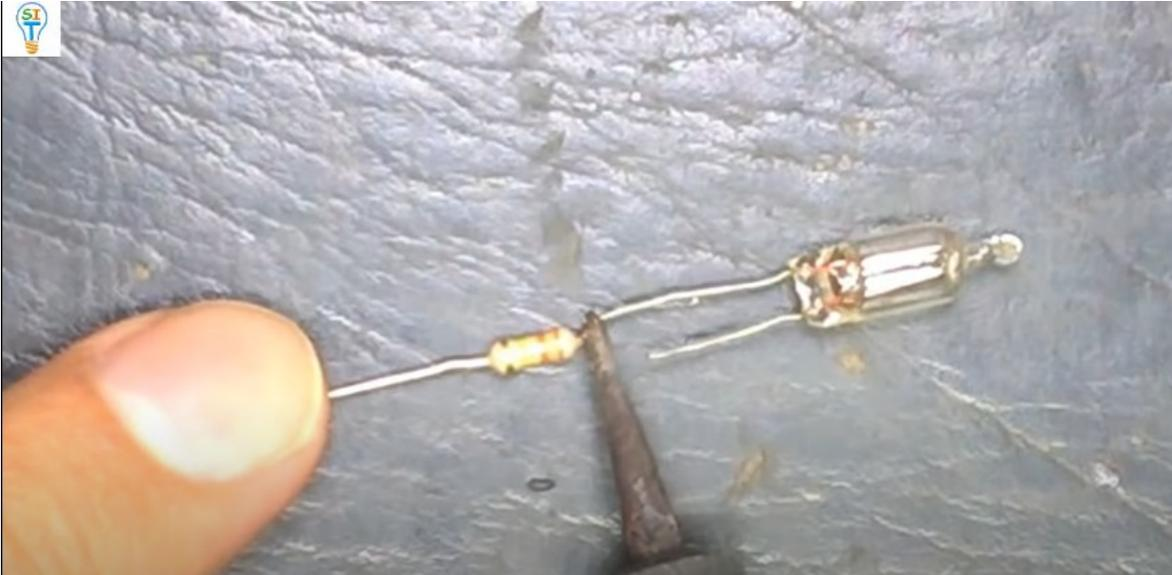
Raspar la punta del cable de 0.3mm
