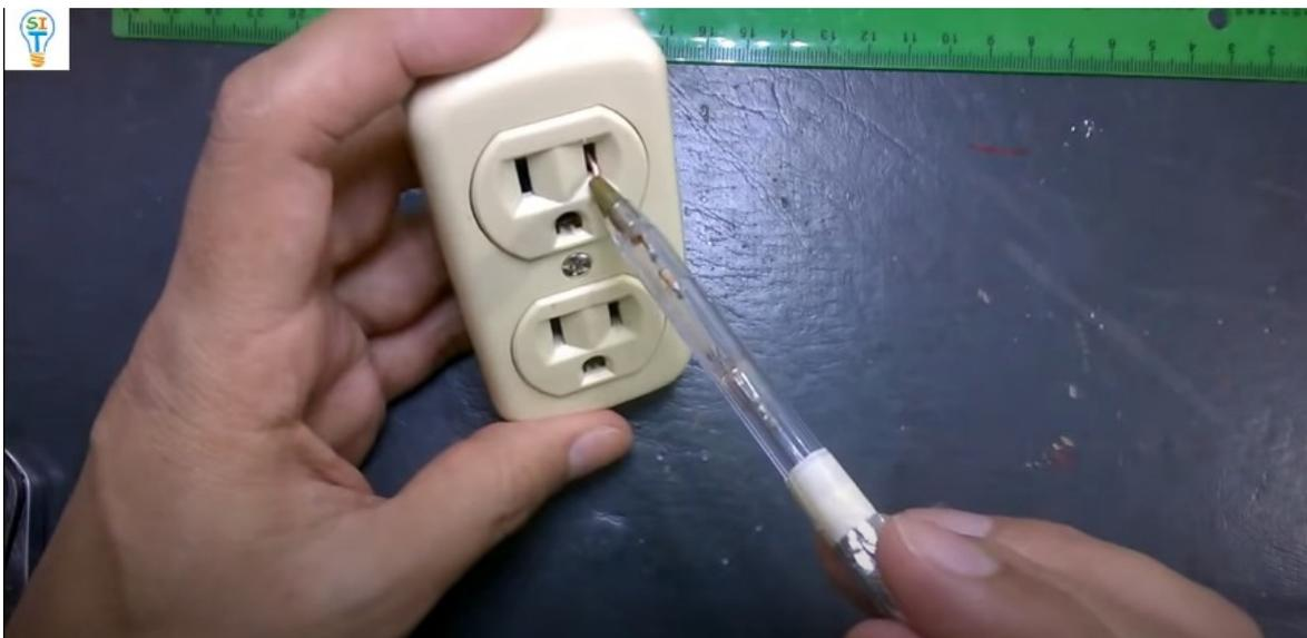
En la otra entrada si encendió. Solamente insertar la punta e inmediatamente se ilumina la lámpara de neón.
