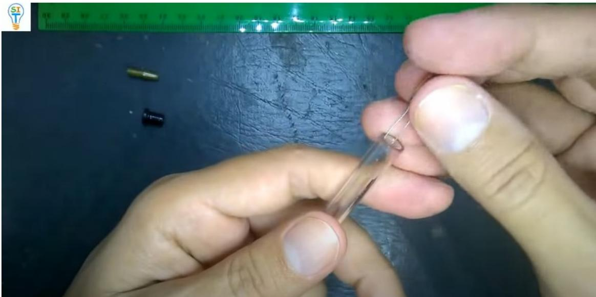
Cortar un pin de la resistencia.
