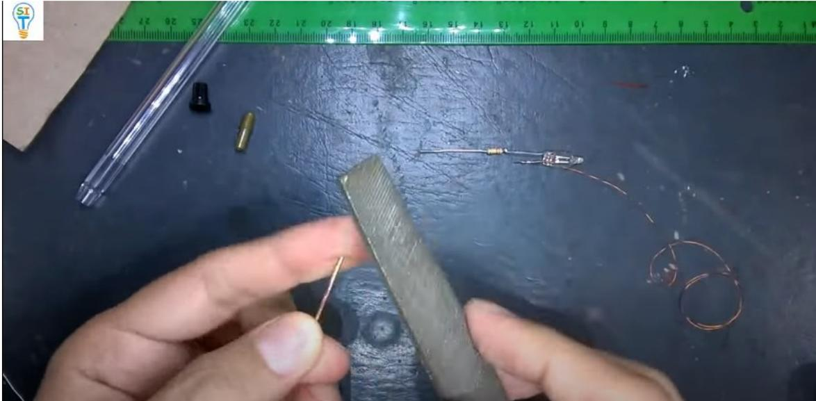
Con la pinza hacer al alambre dos ángulos creando la forma que se ve en la imagen. Estos ángulos ayudaran a que la punta no se hunda cuando se instale en la base.
