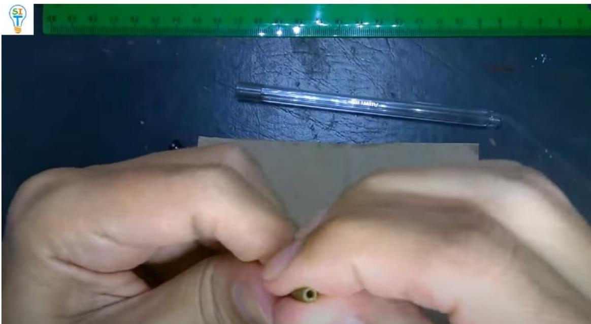
Insertar nuevamente la punta de la tinta sin la base, en el cilindro de tinta.
