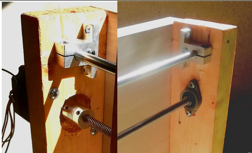
*Fijación de las barras por los soportes de aluminio.*
