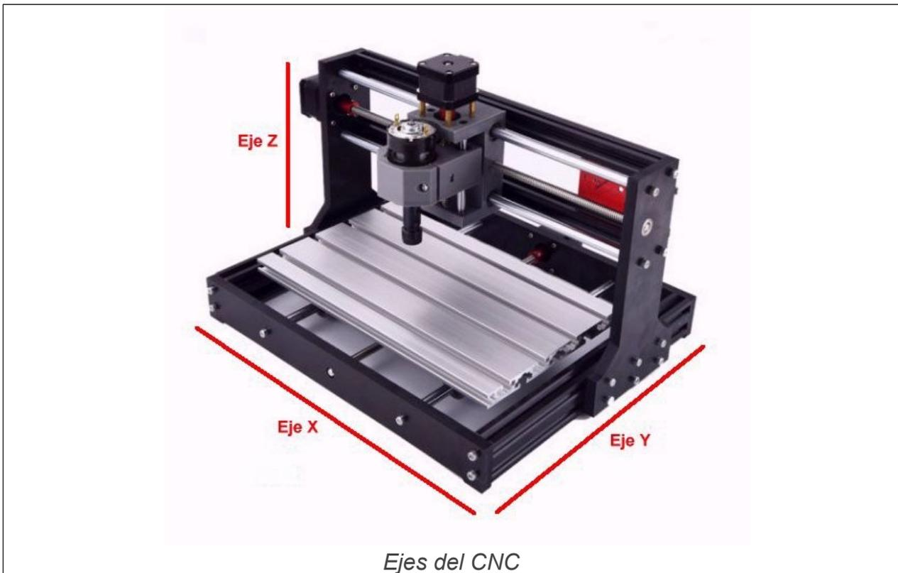
Por sus características un CNC puede moverse y cortar en tres direcciones a las que comúnmente se hace referencia como direcciones X, Y y Z. El eje X suele ser el de mayor recorrido de derecha a izquierda, luego está el eje Y que se mueve de delante a atrás y el eje Z que corre de arriba a abajo, en la imagen anterior se pueden ver las etiquetas respectivas.
