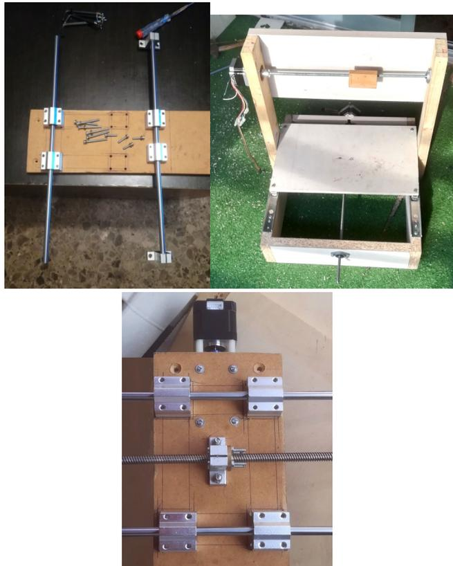
*Soportes varillas lineales eje X.*
